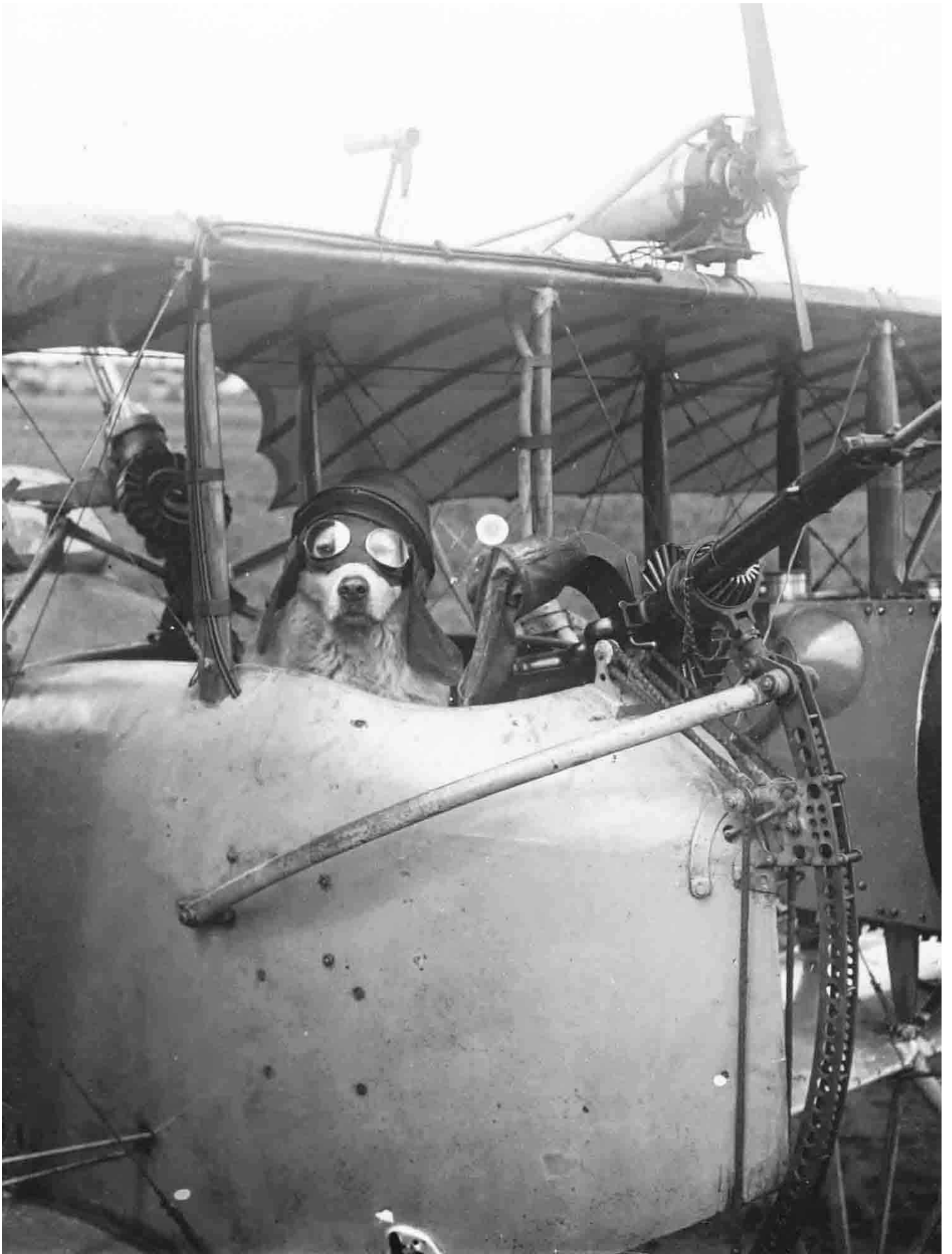
▲ Ce chien nous montre l'armement d'un Caudron G.4, avec ses deux mitrailleuses et, sur l'aile, la génératrice électrique
